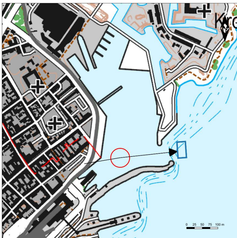
Figur 1 Konceptuel model for udledningen af vand fra renseløsningen til initial opblanding (rød cirkel) i det åbne havnebassin, og efterfølgende udstrømning gennem havneåbningen til vandstrømning nord-syd i Øresund.
